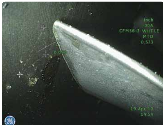
Mesure de jeu entre carter et aube de turbine
