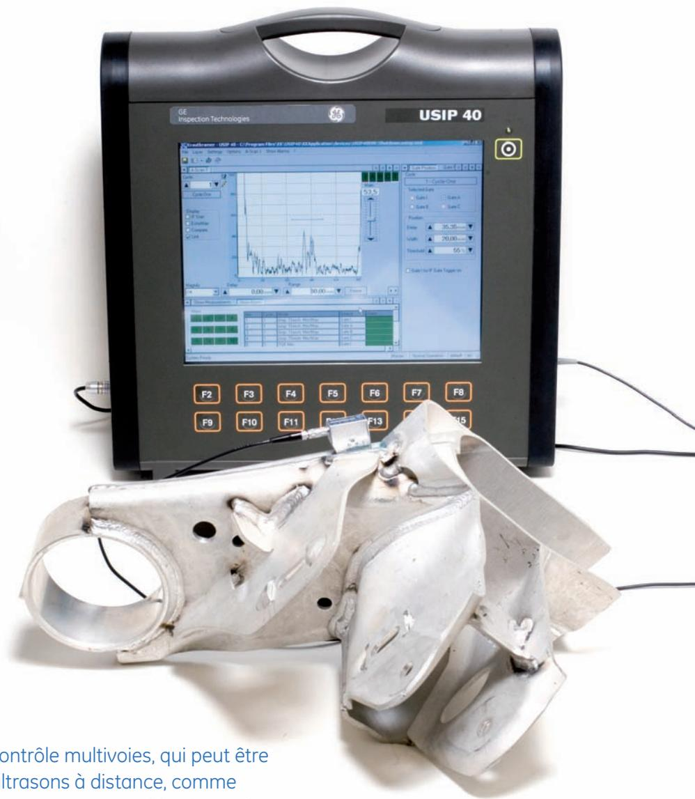
L'appareil USIP 40 est une plateforme de contrôle multivoies, qui peut être configurée comme unité de contrôle par ultrasons à distance, comme appareil intégré dans une baie ou comme instrument portable alimenté par batteries. Toutes les versions de l'USIP 40 profitent des avantages de la même électronique ultrasonore de base, d'une interface utilisateur graphique et d'outils logiciels spécifiques au domaine d'application.
