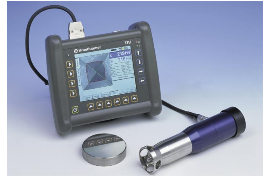
El aparato de ensayo de dureza TIV con palpador y bloque de comparación de dureza: En el palpador hemos introducido alta tecnología – el sistema óptico y la cámara CCD, que permiten la vista a través del diamante. La independencia respecto a la dirección es otra prueba de la tecnología patentada por Krautkramer: Ud. puede medir en todas las direcciones - sin ajustes adicionales.
