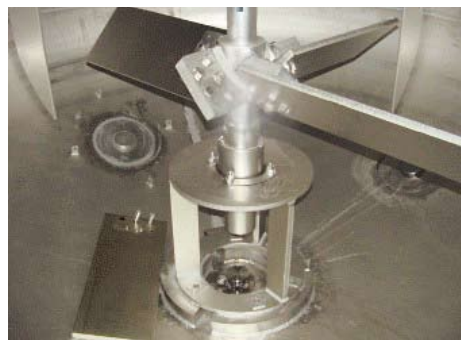
Hoja del agitador aislada en la vasija de mezclado debido a pernos rotos
