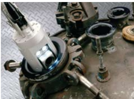
Inspección mediante una boca de 100 mm (3,94 pulg.) de diámetro
