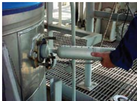
Inspección de vasija forrada de cristal mediante la inspección del tanque farmacéutico mediante una boca de 76 mm (3,0 pulg.)
