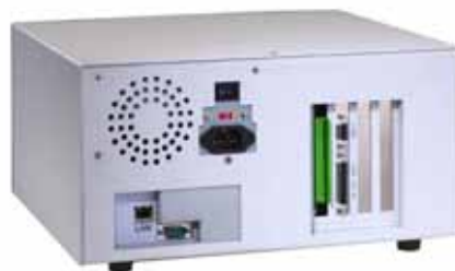
La configuración "Plug and play" se logra fácilmente con conectores estándar para salidas de alimentación, sensor y analógicas.
