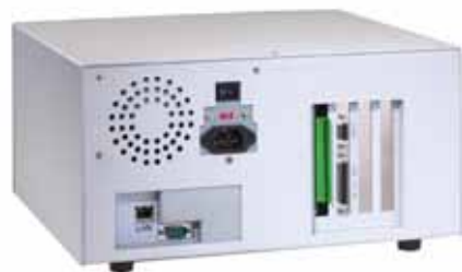
„Plug and play“-Setup einfach über Standardanschlüsse für Strom, Sensor und Analogausgänge.
