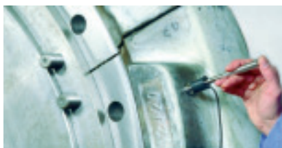
鍛造品の硬さ測定
