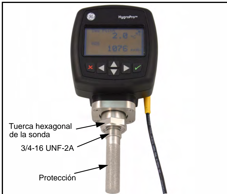
Figura 2: Instalación de HygroPro
