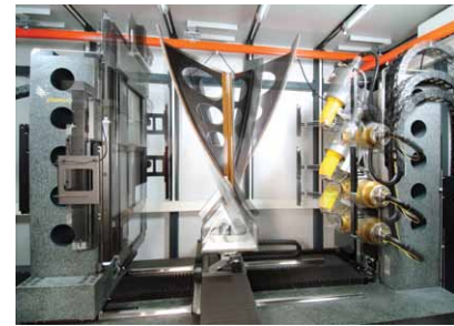
Verfahren aller Achsen: v|tome|x L 450 am Deutschen Zentrum für Luft- und Raumfahrt DLR
