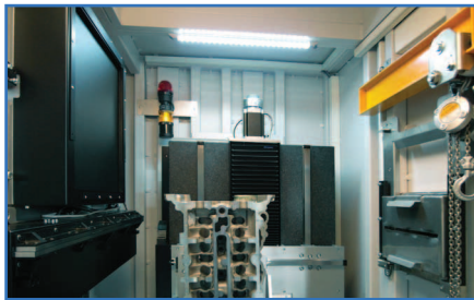
CT-Scan eines Zylinderkopfes
