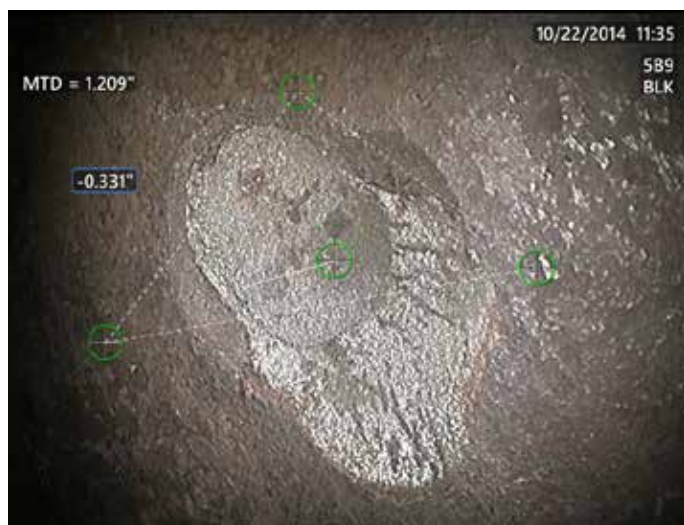
Oberflächengrube Normalansicht mit Tiefe
