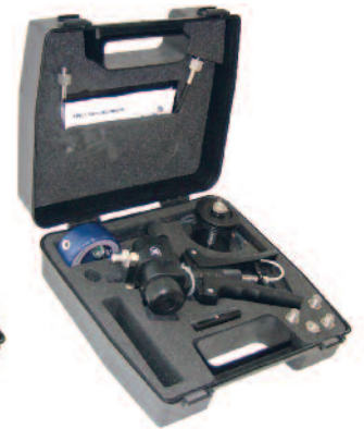
Kit de pruebas neumáticas e hidráulicas
