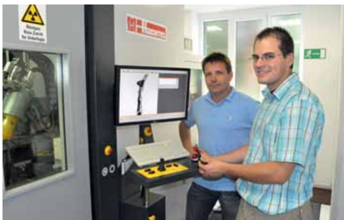
Bild 2. In einem begehbaren Computertomografen werden Kunststoff- und Leichtmetallbauteile von bis zu 400 mm Durchmesser und 1.200 mm Höhe untersucht.
