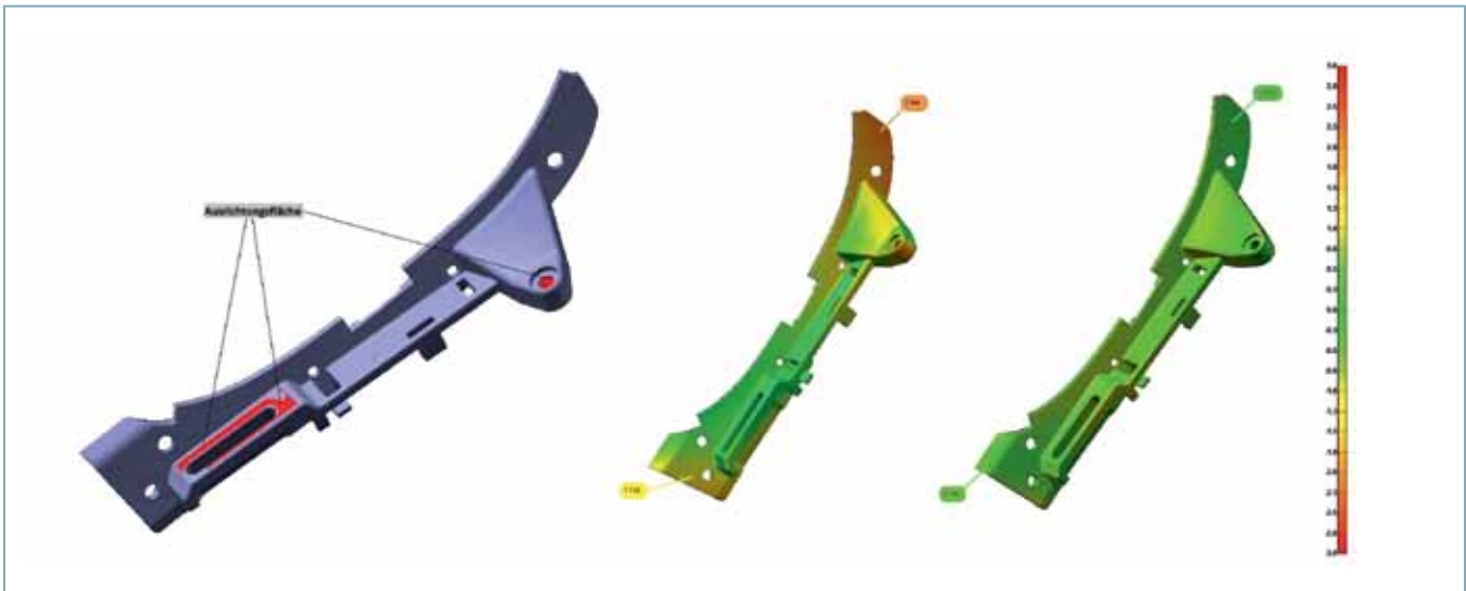
Bild 1. Ausrichtflächen an einer Kunststoffhalteleiste (links). Eine simulierte, korrigierte Ausrichtung des gescannten Bauteils (rechts) zeigt, dass die Formtreue des Bauteils besser ist, als der ursprüngliche Soll-Ist-Vergleich (Mitte, Ausrichtung nach Referenzpunktsystem) vermuten ließ.
