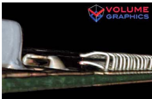
Abb. 14: Bondverbindung der gestapelten Speicher-ICs in 3D-Darstellung (links) und als virtueller Schnitt
