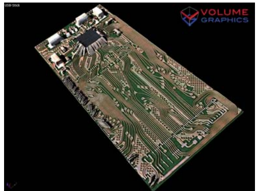
Abb. 13: Rekonstruktion und Visualisierung der segmentierten Leiterbahnen in der CT-Aufnahme des USB-Sticks
