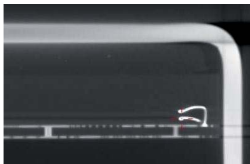
Abb. 14: Bondverbindung der gestapelten Speicher-ICs in 3D-Darstellung (links) und als virtueller Schnitt
